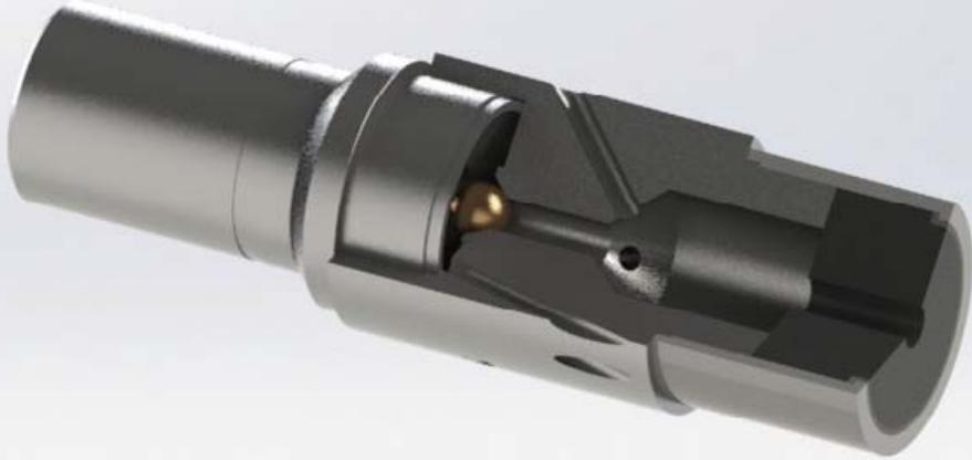
反循环强磁打捞器是石油、地质钻探中打捞井下小件落物的打捞工具。在打捞作业时，可在井底形成局部反循环，落鱼被冲到打捞篮内，利用本身所带永久磁铁将牙轮、巴掌、大钳牙及工具等小件落物磁化吸住。
